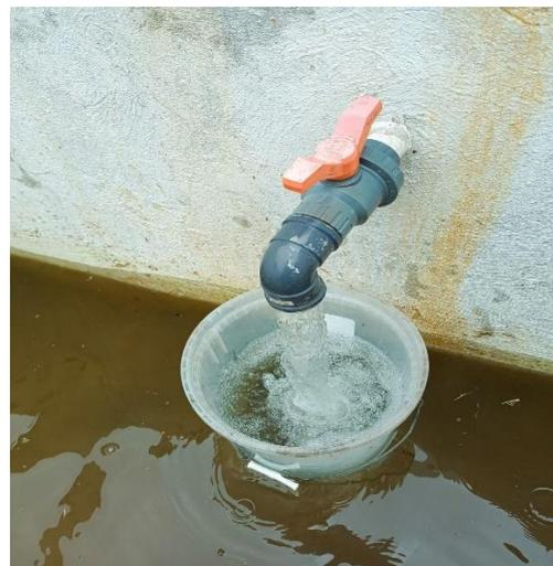
**Foto 12 Agua drenada del lisímetro**
