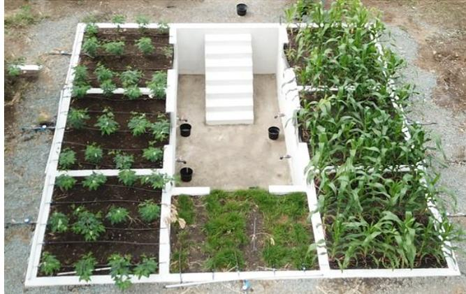
**Figura 1.1 Lisímetro de drenaje ubicado en ESPOL**
