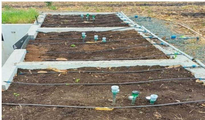
Figura 2.5 Tensiómetros colocados en cada una de las capas del lisímetro
