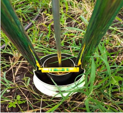
Foto 1 Infiltrómetro nivelado
