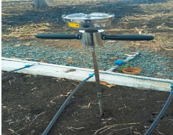
**Figura 2.3 Penetrómetro manual utilizado en el lisímetro de drenaje**
