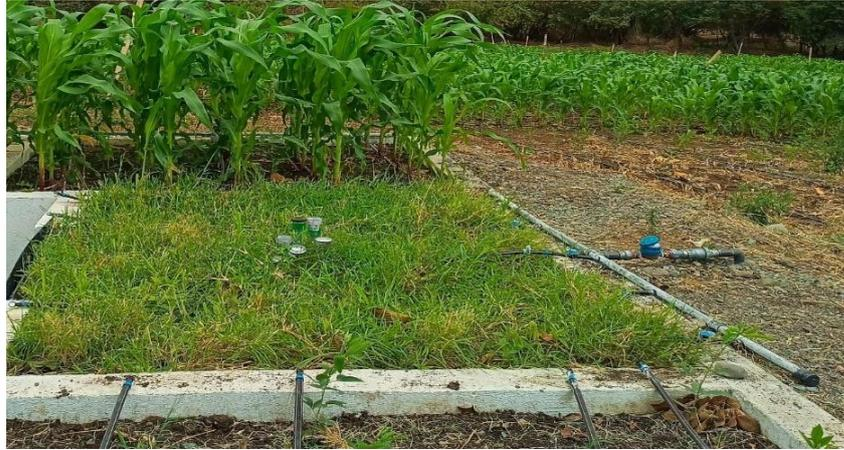
**Figura 2.8 Medidor ubicado al costado del lisímetro 4**
