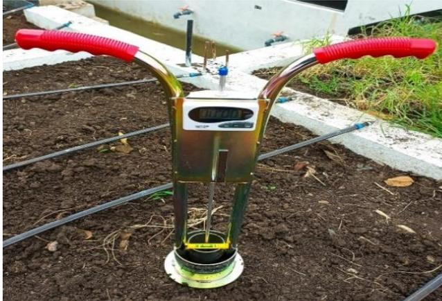
**Figura 2.4 Infiltrómetro Turf Tec utilizado en el lisímetro de drenaje**
