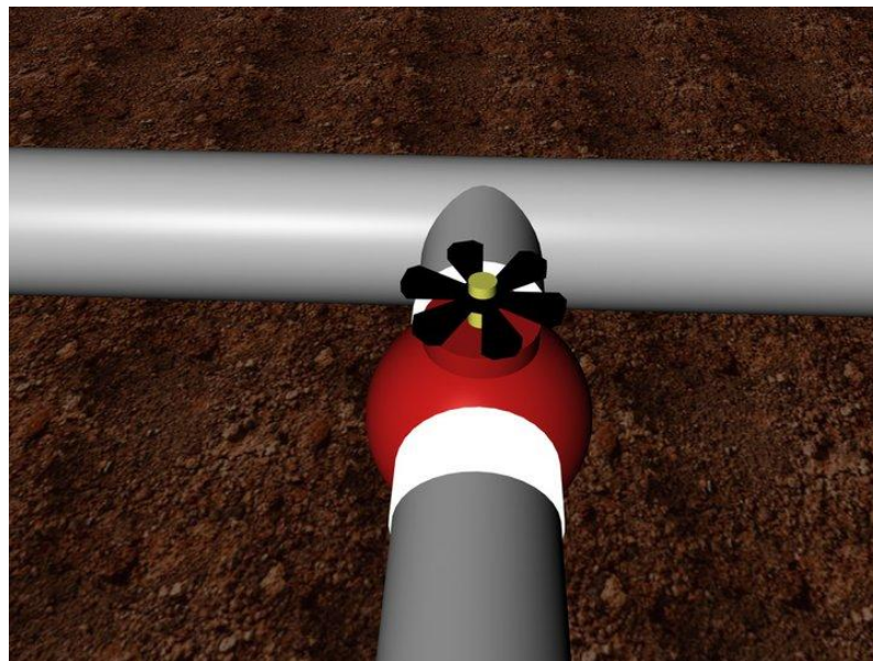
Llave de paso en tubería secundaria
