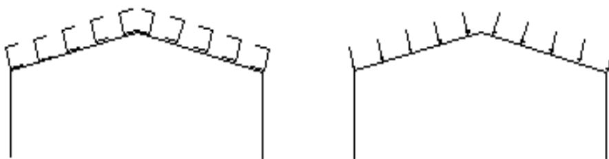
FIGURA 1.6. CONDICIÓN DE CARGA DEBIDA A LOS LARGUEROS
