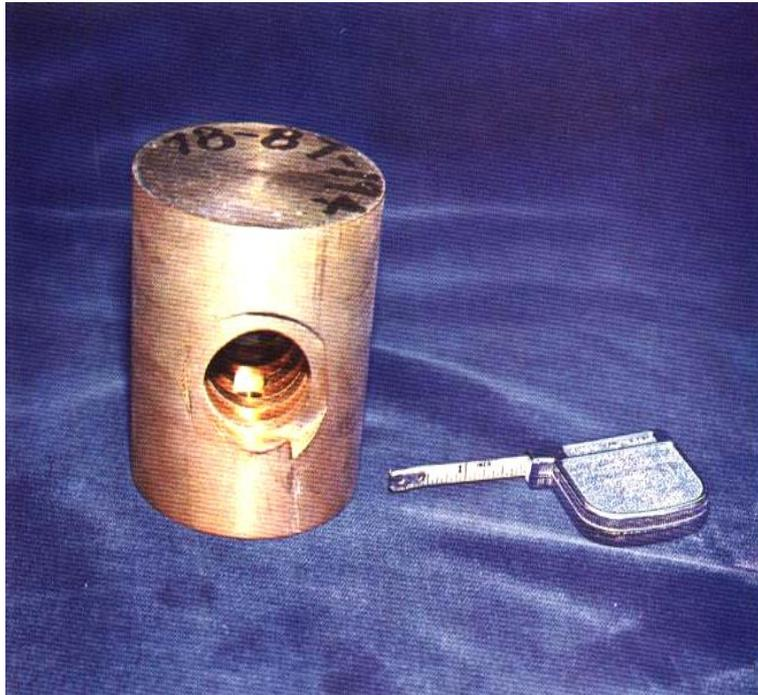
Fig. 1.2 .- Tuerca niveladora para molino giratorio. Bronce al estaño ( Cu 87, Sn 11, Ni 2 ).
