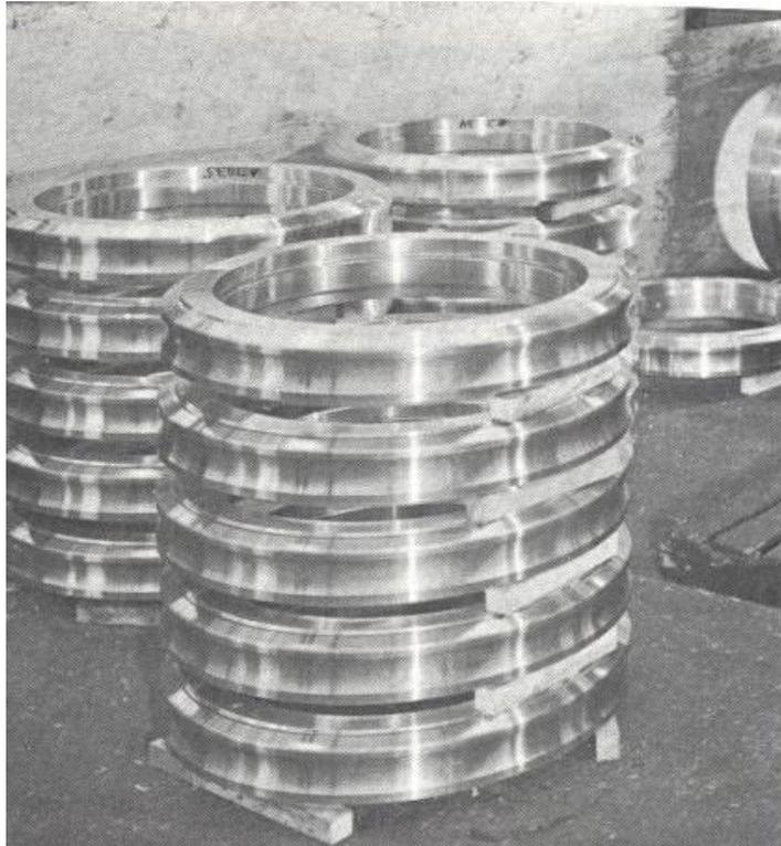
Fig. 1.14 .- Coronas para sistemas sin-fin corona. SAE 65 (89Cu, 11Sn)
