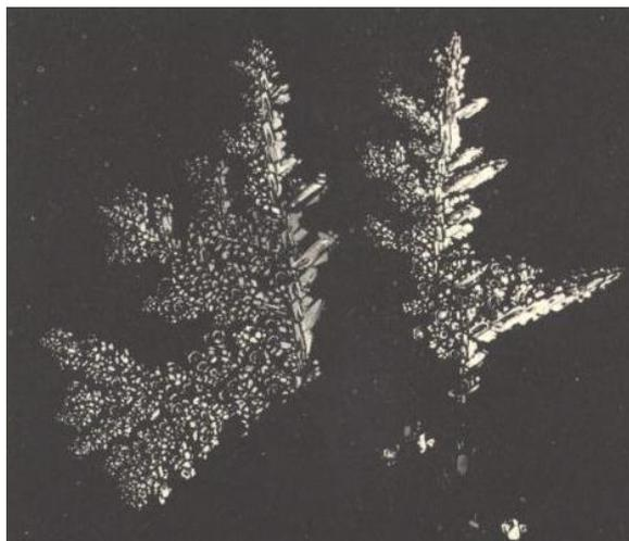
Fig. 1.10 .- Crecimiento de dendritas en el magnesio líquido
