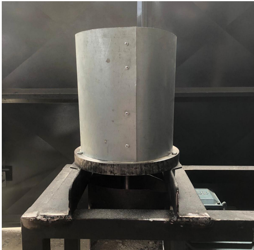
Figura 3.6 Ensamble de equipo con tolva cilíndrica provisional
