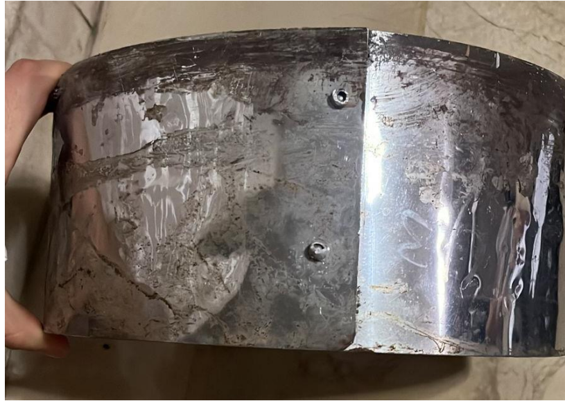
Figura 2.7 Olla de equipo. Material: Lata 0.5mm espesor
