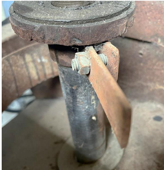
Figura 2.12 Forma y acabado superficial de cuchilla
