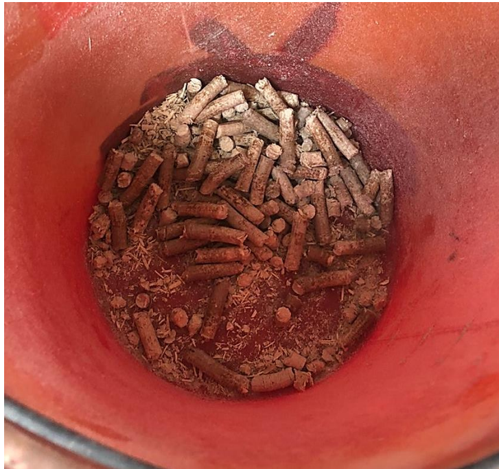
Figura 4.8 Pellets obtenidos post-producción
