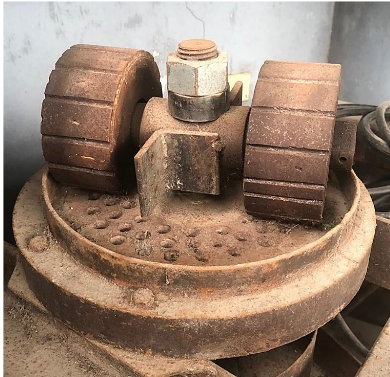
Figura 2.10 Sistema Muelas-Matriz. Estado inicial de equipo.
