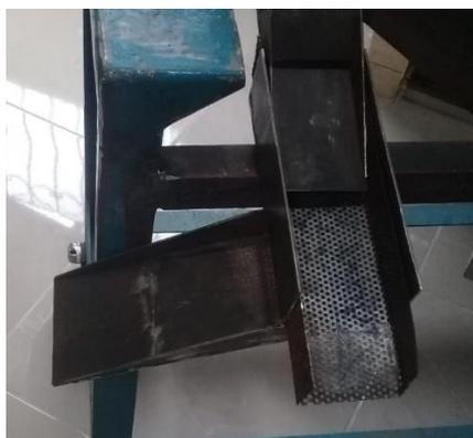
**Ilustración 2.27 Zaranda clasificadora a la salida del equipo**
