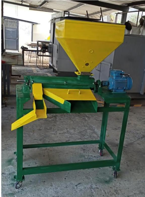
**Ilustración 3.2** Diseño final de piladora de arroz en físico
