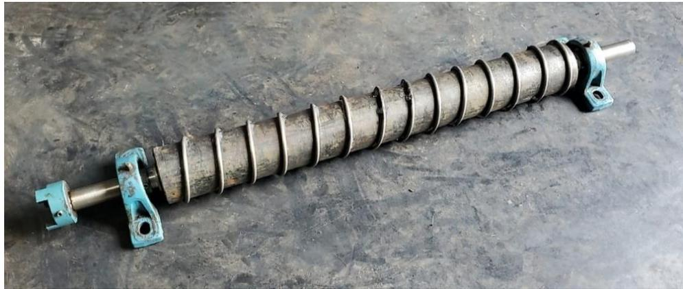
**Ilustración 2.3 Ensamble del tambor con chumaceras y acople**
