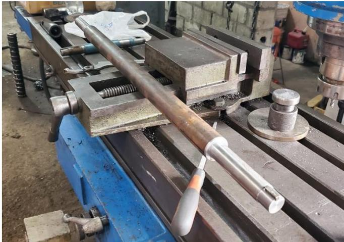
**Ilustración 2.1 Mecanizado de extremos del eje**
