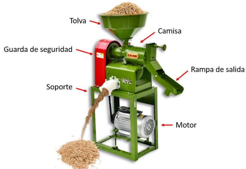
**Ilustración 1.5 Piladora en configuración tambor rotatorio [3]**
