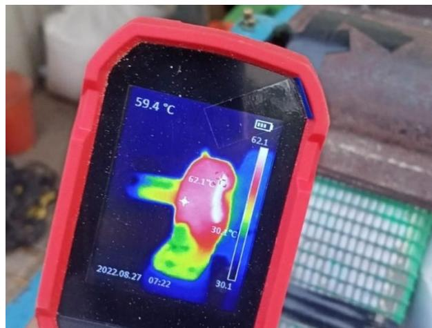
**Ilustración 2.32 Temperatura del cojinete luego del cambio de lubricante**
