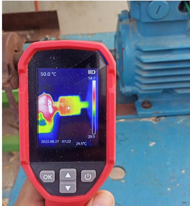
**Ilustración 2.31 Temperatura del acople luego del cambio de lubricante**
