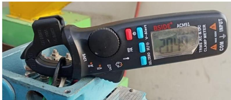
**Ilustración 2.33 Medición de corriente en el embobinado durante la operación**
