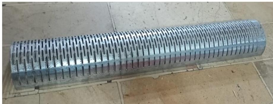
**Ilustración 2.15 Criba de piladora de arroz**
