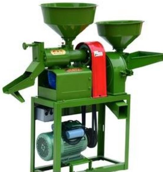
**Ilustración 1.4 Piladora de baja capacidad con tambor giratorio [3]**
