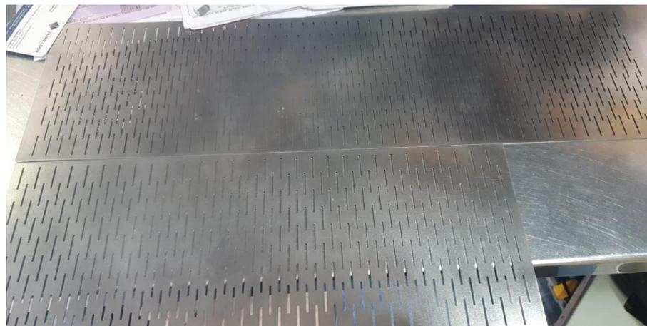
**Ilustración 2.24 Cribas con perforaciones de 1x20 mm**
