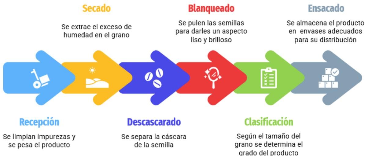
**Diagrama 1.1 Proceso de pilado del arroz**
