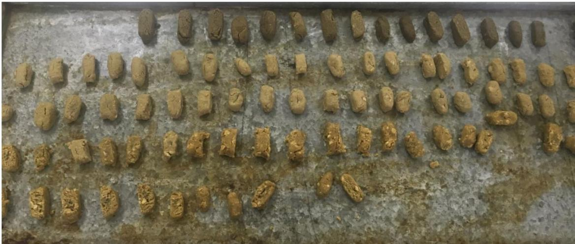
Figura 4.8.- Premezclas a la salida del extrusor, previo al secado
