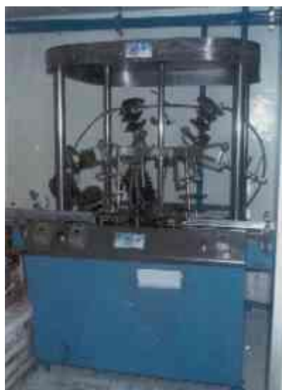
FIG. 3.3. ENJUAGADORA DE BOTELLAS SEMIAUTOMÁTICA ROTATIVA.
