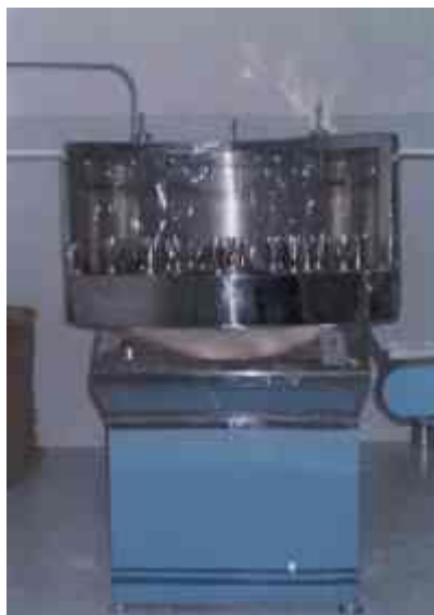
FIG. 3.4. ENJUAGADORA DE BOTELLAS AUTOMÁTICA ROTATIVA.
