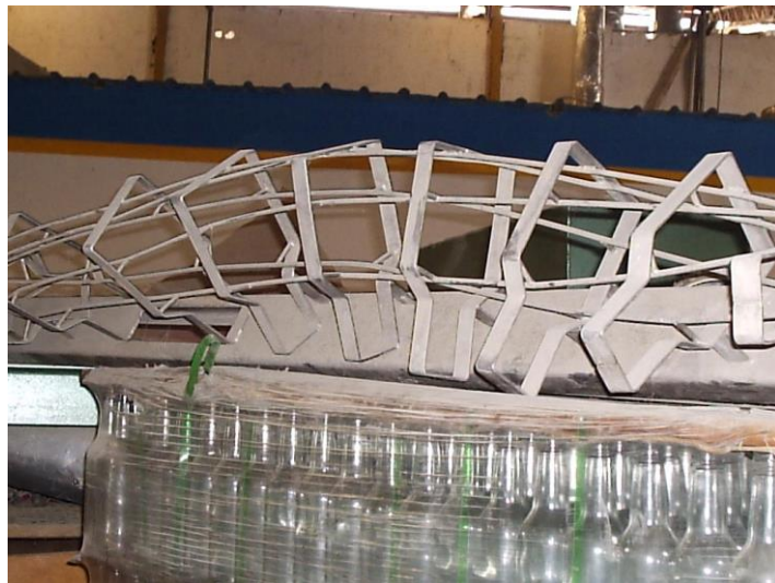
FIG. 3.2a. TWISTER PARA BOTELLAS PEQUEÑAS.
