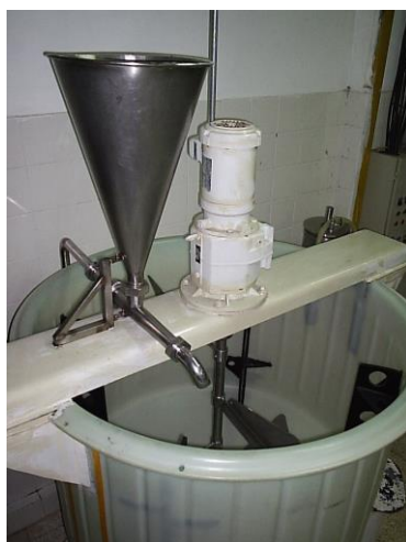
FIG. 1.7 TANQUE DE MEZCLA.
