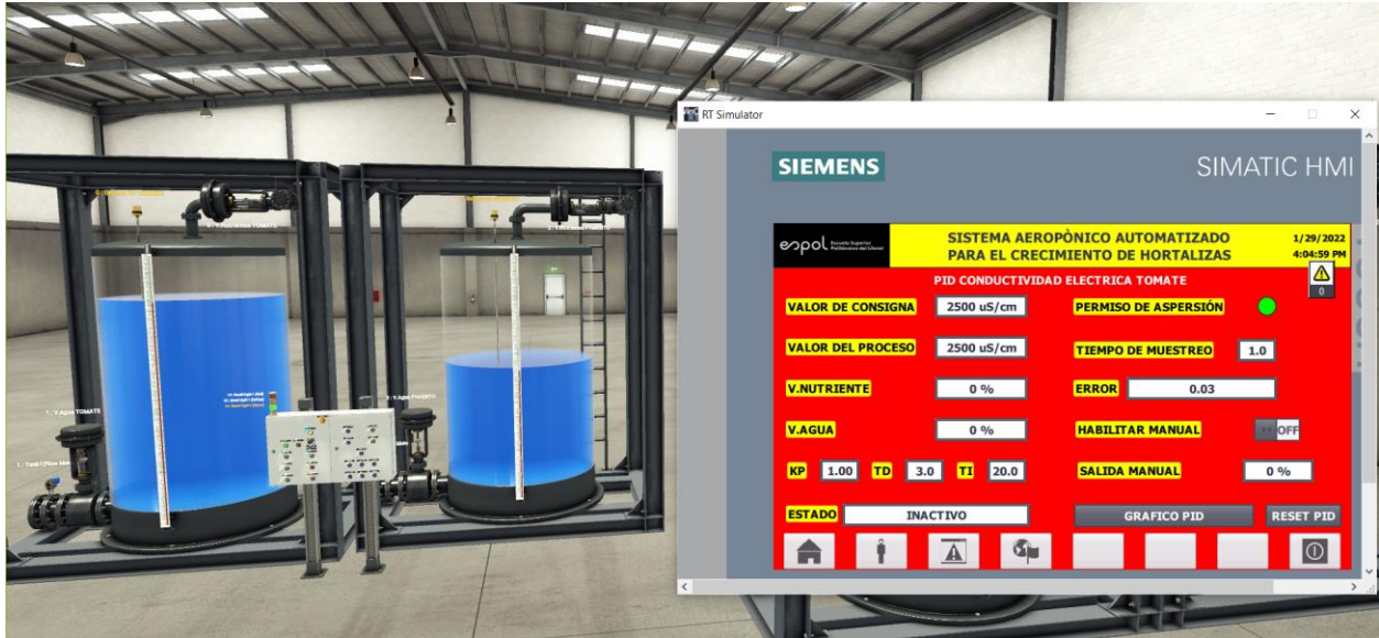
Ilustración 28 Simulación del sistema con PLC SIM y Factory IO
