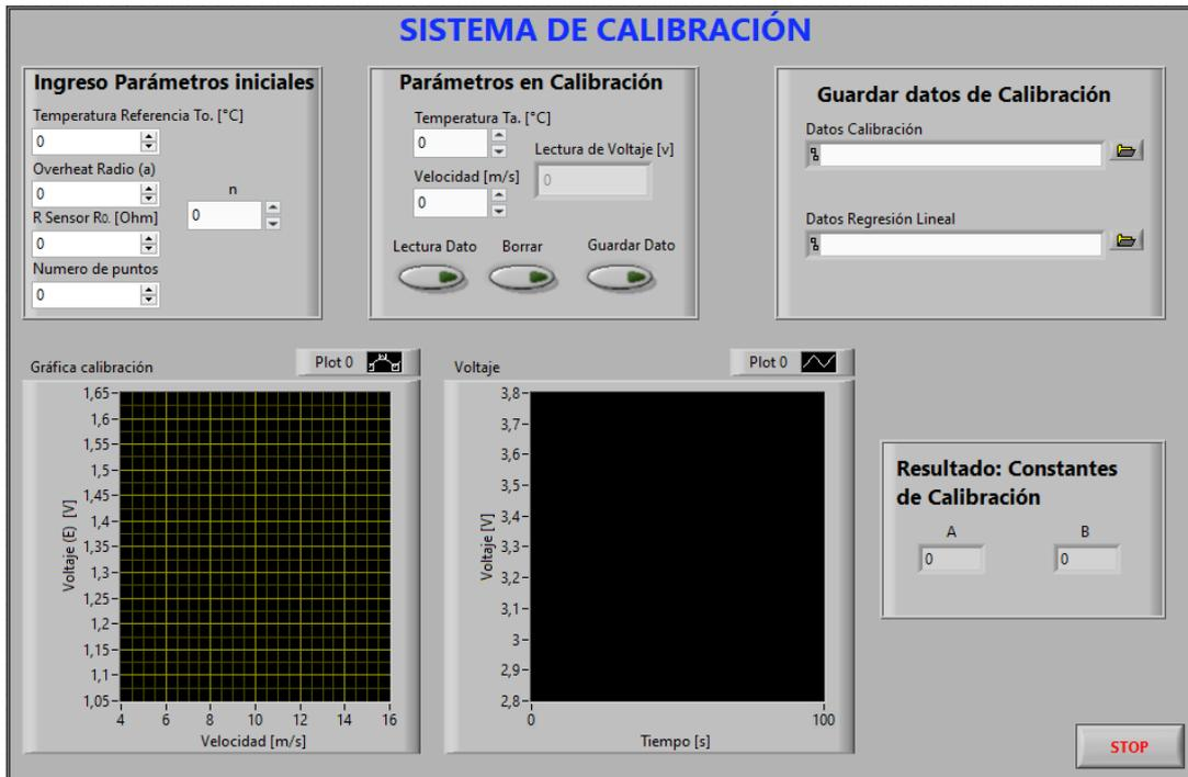
Figura 4.2 Pantalla de calibración
