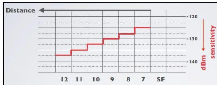
**FIGURA 2.15 Sensibilidad del receptor ante incremento de SF [24]**
