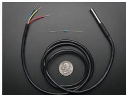
**FIGURA 3.10 – Sensor Digital de Temperatura Adafruit Waterproof DS18B20 [15].**
