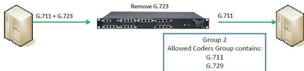
Figura 2.7 Eliminación de códecs en una transacción de telefonía. [5]
