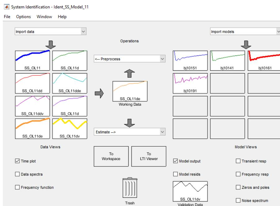
**Figura 2.15. Herramienta System Identification ToolBox para estimación de parámetros del sistema de cristalización de azúcar.**
