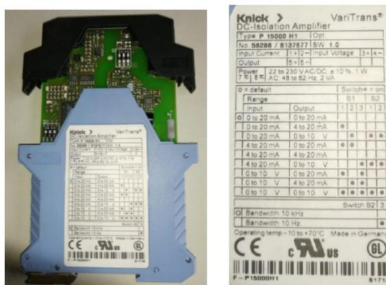
Figura 2-15 Convertidor de señal Varitrans Type P 15000 H1
