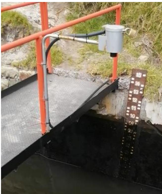
**Figura 4-5 Verificación y comprobación del nivel de agua**
