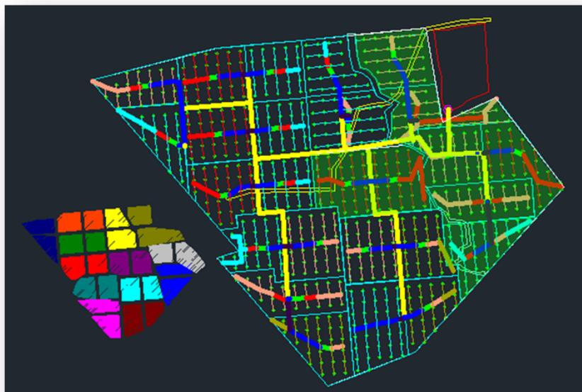
Figura 3.4 Plano de la finca con estación de bombeo, albarrada, tuberías primarias, secundarias y laterales, válvulas, entre otros, realizado en AutoCAD. [Creado por el Autor]
