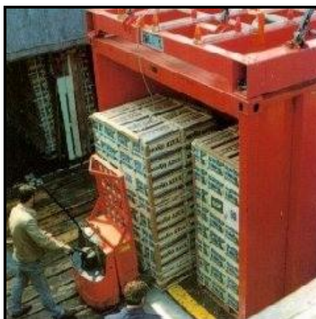
FIGURA 3.6. FORMA DE UNITARIZACION COMBINADA
