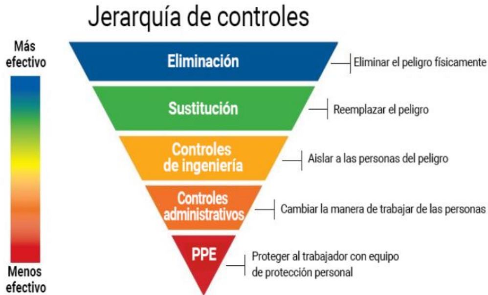
Figura 3.1 Jerarquía de control de riesgos
