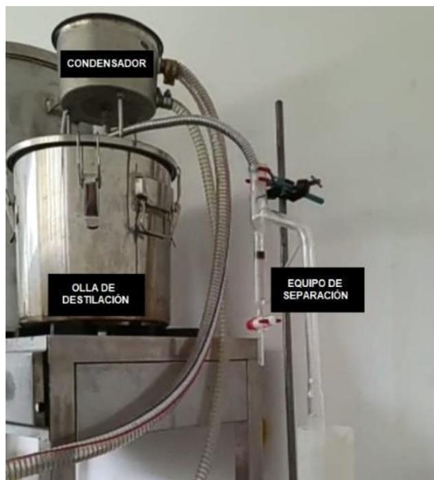
**Figura 2.2** Equipo de destilación utilizado
