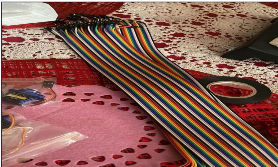
Figura 3.21. Cables de conexión de 40 cm de largo para conectar los sensores ultrasónicos con la tarjeta Arduino Mega 2560.
