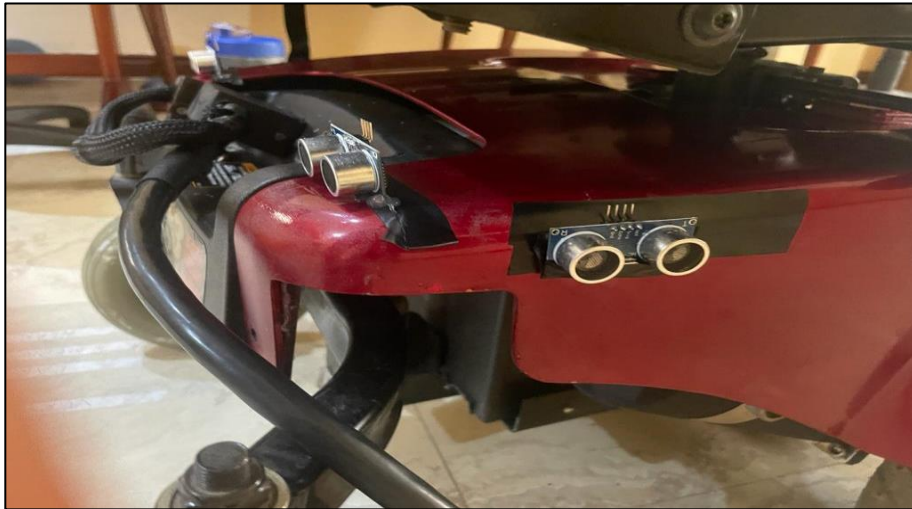
Figura 3.24. Acoplamiento de sensores ultrasónicos en la silla de ruedas eléctrica.
