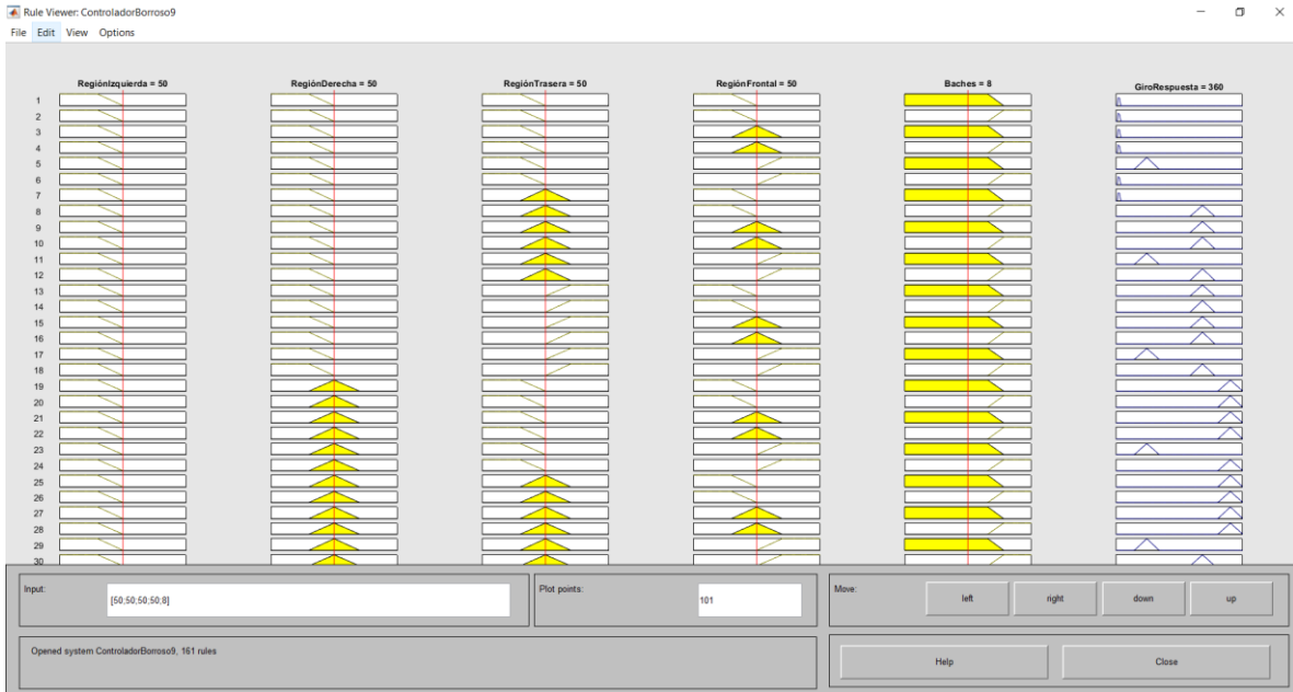
Figura A.32. Defuzificación por el método del centroide del controlador borroso 2.
