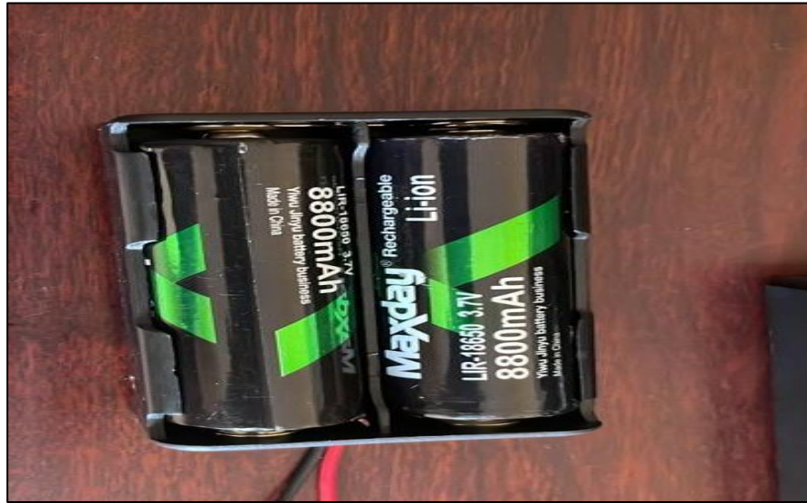
Figura 3.28. Baterías litio – ion recargables de 3,7 V y 8800 mAh acopladas al mecanismo de los servos motores.
