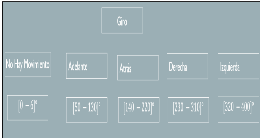
Figura 3.12. Representación de los intervalos de las funciones de pertenencia para la variable de salida.
