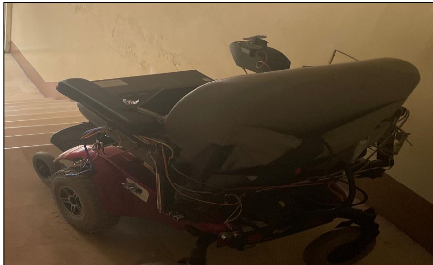
Figura 4.6. Implementación final del control borroso para la evasión de obstáculos en la planeación de la silla de ruedas eléctrica Jazzy Jet 3.
