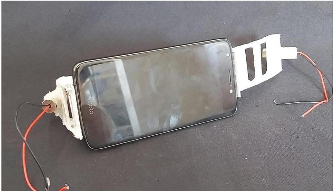
**Figura 3.13. Prototipo a base de cartulina pancacoa del sistema de adquisición de datos (vista trasera).**
