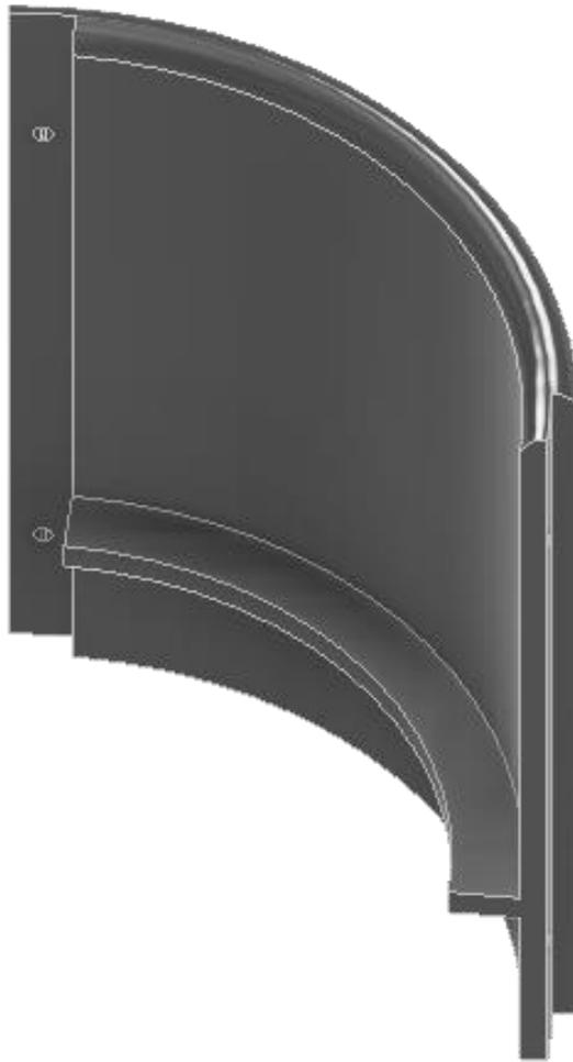
**Figura 3.5. Sección parcial de la carcasa del escáner 3D, el cual necesitará tres de esta sección para formar  $\frac{3}{4}$  de la carcasa exterior.**
