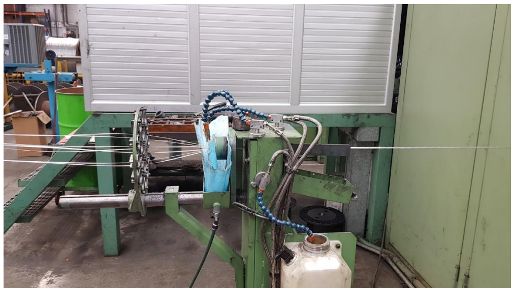
Figura 1.8 Proceso de reunido de hilos de aluminio
