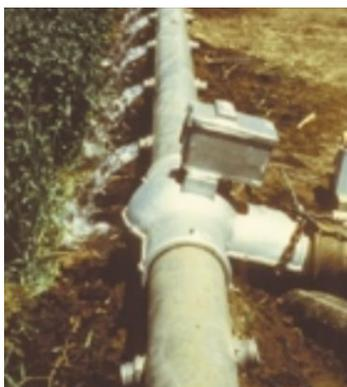
*Ilustración 2.25: Riego por surco de flujo de oleaje [79].*
