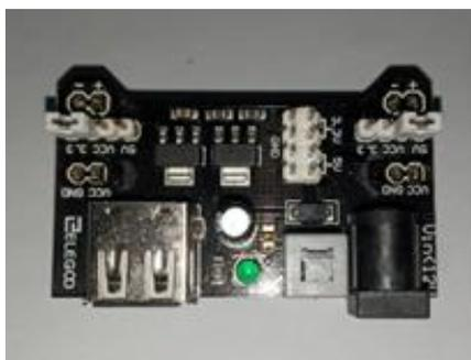
*Ilustración 3.41: Fuente de voltaje DC de 3.3V y 5V.*
