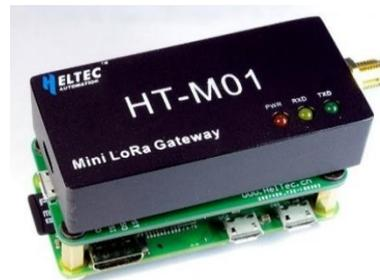
*Ilustración 2.5: Módulo HT-M01 Mini LoRa Gateway [36].*
