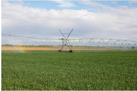
*Ilustración 2.26: Riego por aspersión con pivote central.*
