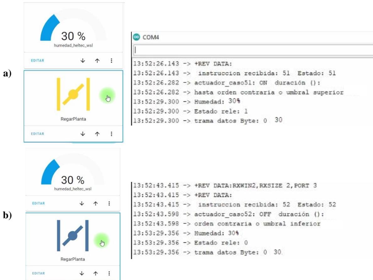
**Ilustración 4.16: a) Encendido forzoso de riego b) Apagado forzoso de riego**
