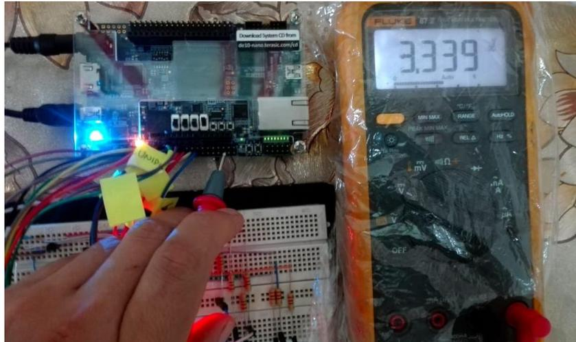
**Figura 3.26: Medición del pin salida[2] que posee un valor de 3.33 V aproximadamente**
