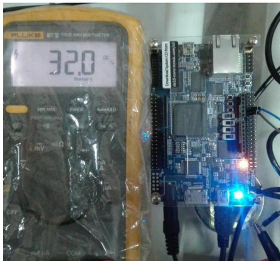
**Figura 3.17: Lectura del Duty Cycle de la señal PWM generada por el microcontrolador a través del multímetro**
