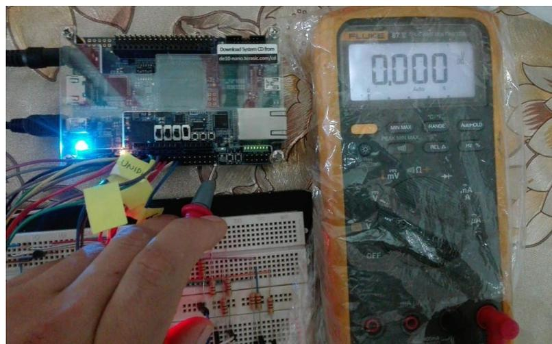
**Figura 3.27: Medición del pin salida[0] que posee un valor de 0 V aproximadamente**
