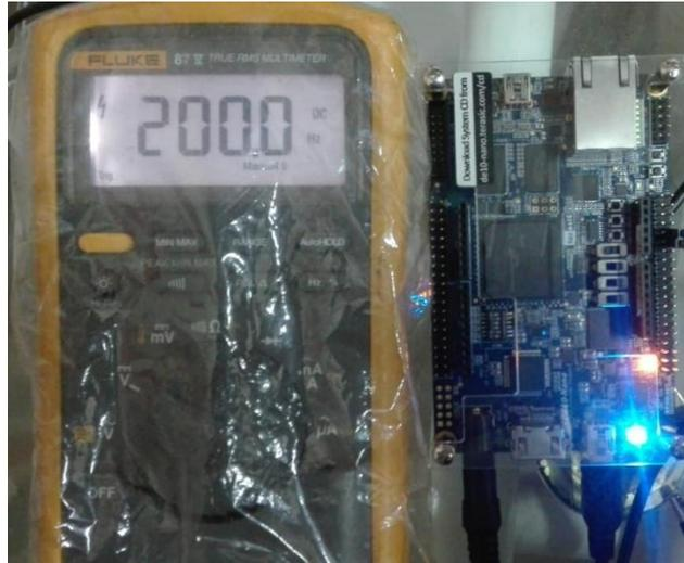
**Figura 3.18: Lectura de la frecuencia de la señal PWM generada por el microcontrolador a través del multímetro**
