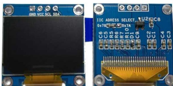
**Figura 2.6 Pantalla OLED Modelo SSD1306**
