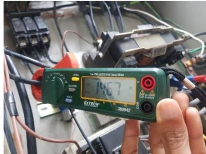
**Figura 2.22 Pinza amperimétrica
