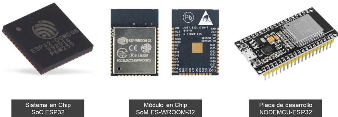
Figura 2.2 Elementos que conforman la placa ESP32
