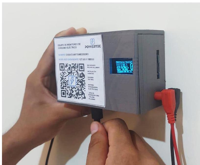
**Figura 2.14 Instalación y conexión del dispositivo físico**
