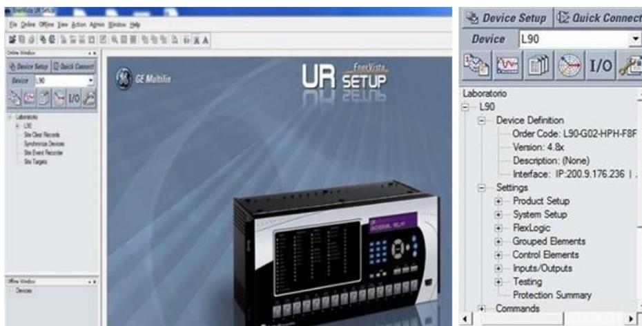
**Figura 2.5 Comunicación del relé L90 con Enervista Setup**
