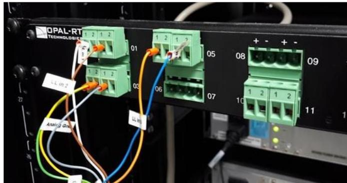
Figura 3.8 Conexión del amplificador CMS 356
