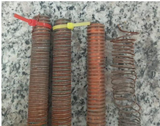
Figura 2.1 Ejemplo de armado de hilos metálicos con tornillos catódicos.
