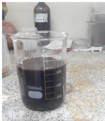
Apéndice A.3 Mezcla homogénea de la solución con plomo para medición de sulfatos
