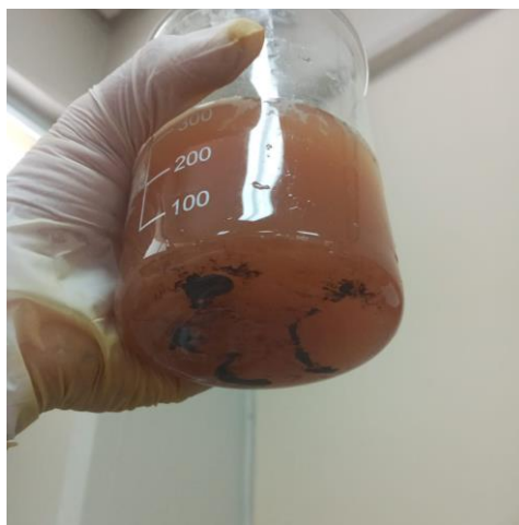
Apéndice B.2 Óxido desprendido post baño
