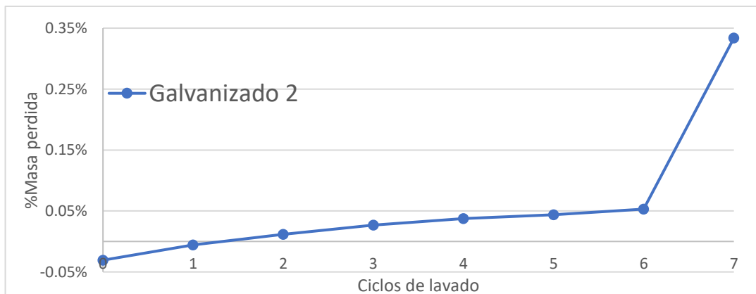
Figura 3.3 Pérdida de masa (%) vs ciclos de lavado – Probetas sin acople galvánico para alambres galvanizados del grupo 2.
