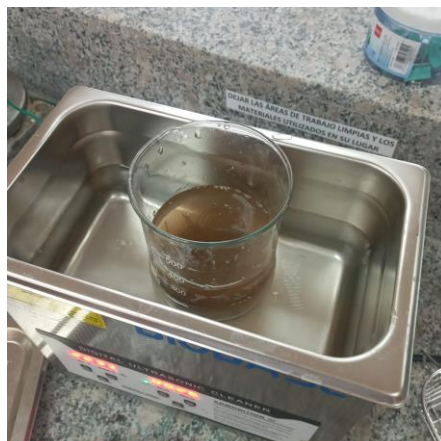
Apéndice B.1 Alambres en baño sónico para remoción de óxido
