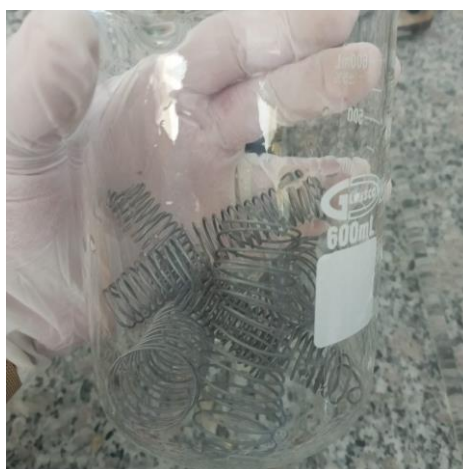
Apéndice B.3 Alambres post limpieza con ácidos
