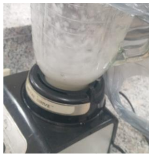
Apéndice A.2 Trituración de papel filtro mediante licuado para fabricar la pasta captadora de sulfatos
