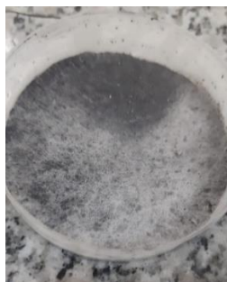
Figura 3.6 Captador de sulfato con recolección significativa
