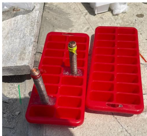
Apéndice A.6 Instalación de acoplos galvánicos para su exposición
