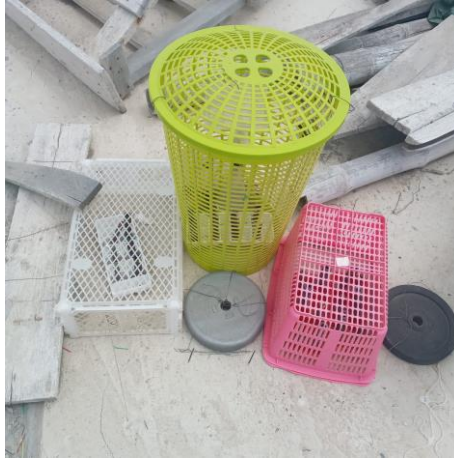
Apéndice A.7 Instalación de los acoples y captadores químicos con protección contra animales locales
