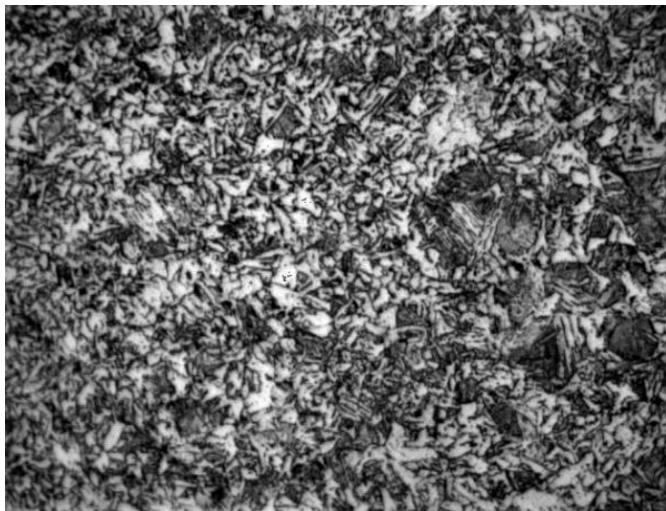
Figura 3.6 Muestra @ 1000X atacado con al Nital 5%, a 2.5 mm del borde.
