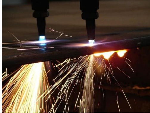
Figura 1.2 Corte por oxicorte [9].
