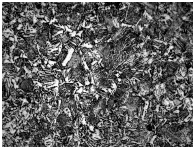
Figura D.5 Muestra @1000x Atacada con Nital al 5%, a 1.5 mm del borde.
