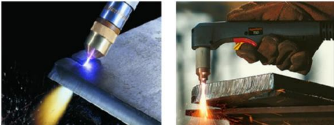
Figura 1.9 Corte por plasma: automatizado izquierda, manual derecha [8].
