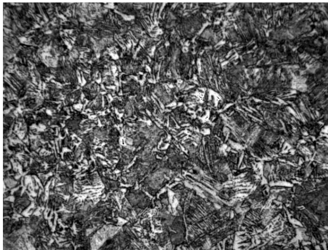
Figura 3.5 Muestra @ 1000X atacado con Nital 5%, a 2 mm del borde.
