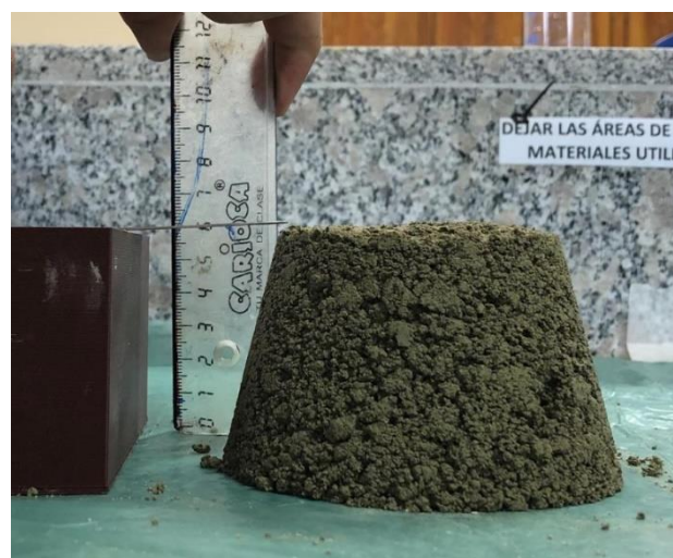
Figura 2. 7 Ensayo de trabajabilidad
