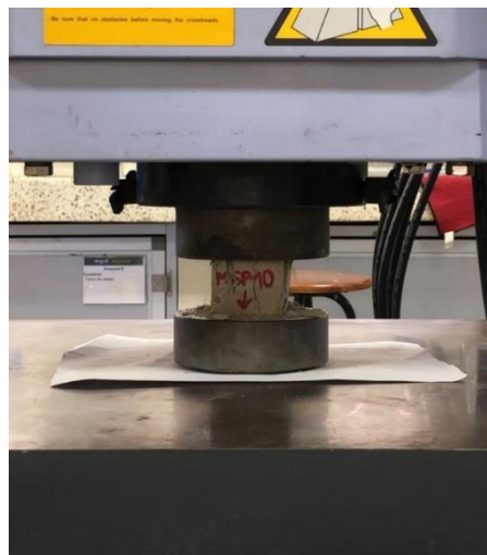
Figura 2. 8 Ensayo de resistencia a la compresión
