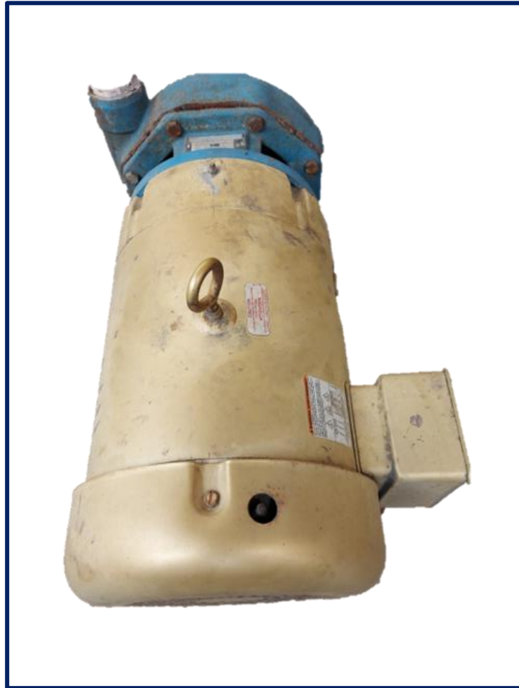
Figura 9 Bomba de agua centrífuga en SICA
