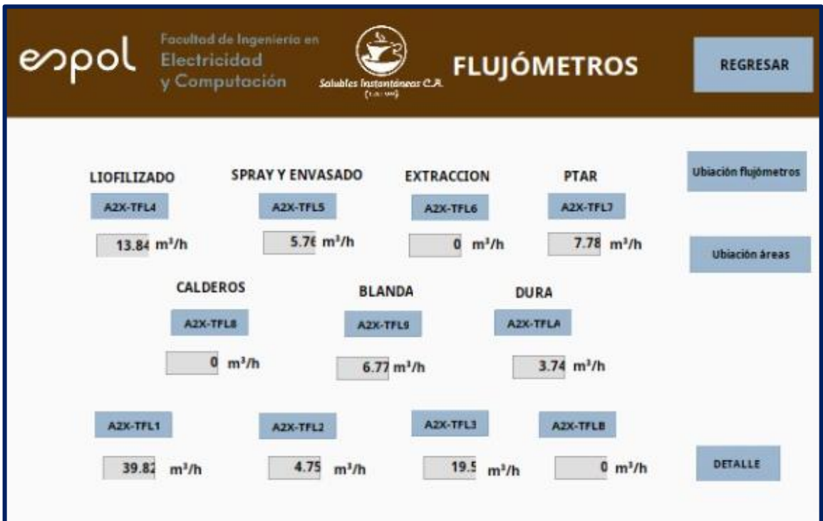
Figura 52. Ventana de flujómetros
