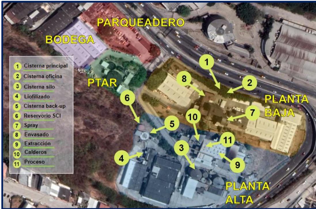
Figura 28 Ubicación de las áreas relacionadas al procesamiento de café soluble y cisternas
