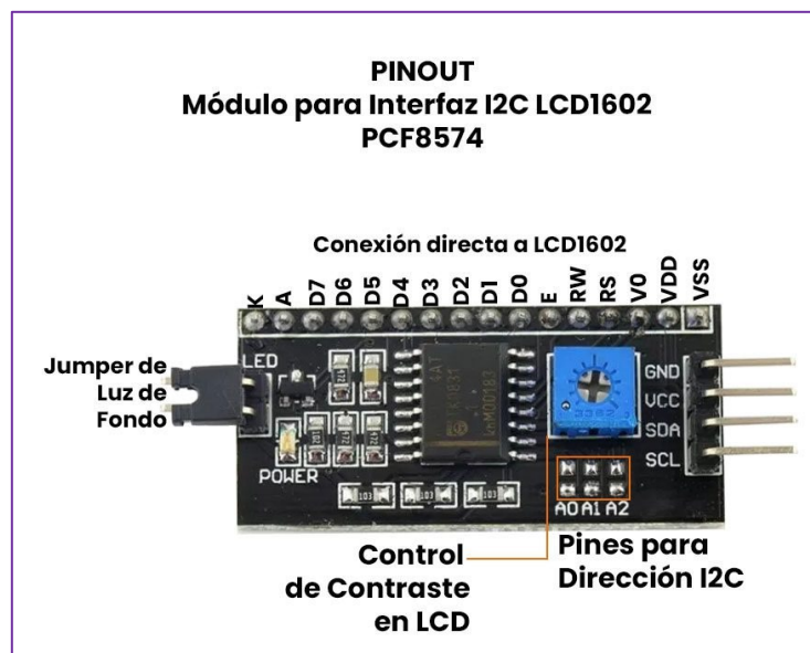
Figura 1.3. “Pinout del módulo para interfaz I2C.”
