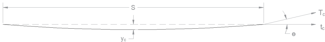
Figura 2.3 Fuerzas de tensión aplicadas en cable
