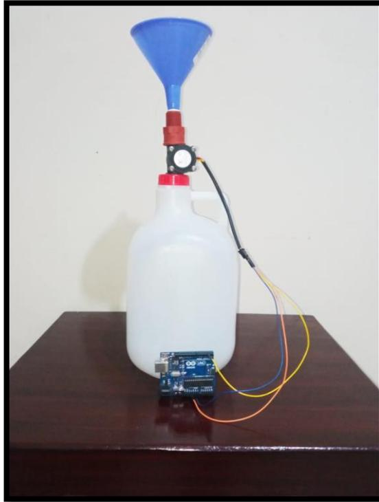
Figura 2.1 Prototipo experimental para recepción de la orina
