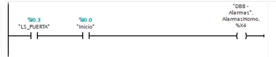
Figura 0.31 Programación de alarma por "Puerta Abierta"
