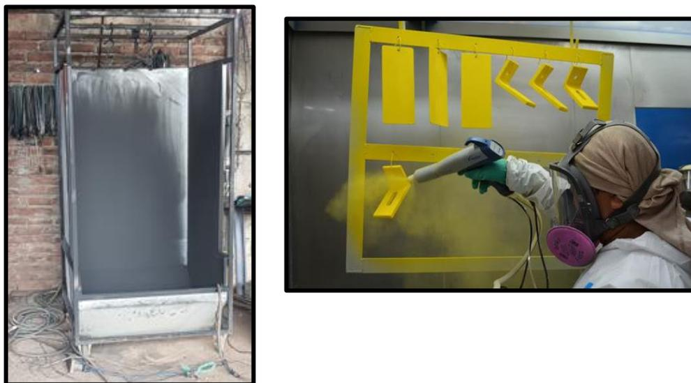
**Figura 0.1 Cabina de pintura electrostática [15]**
