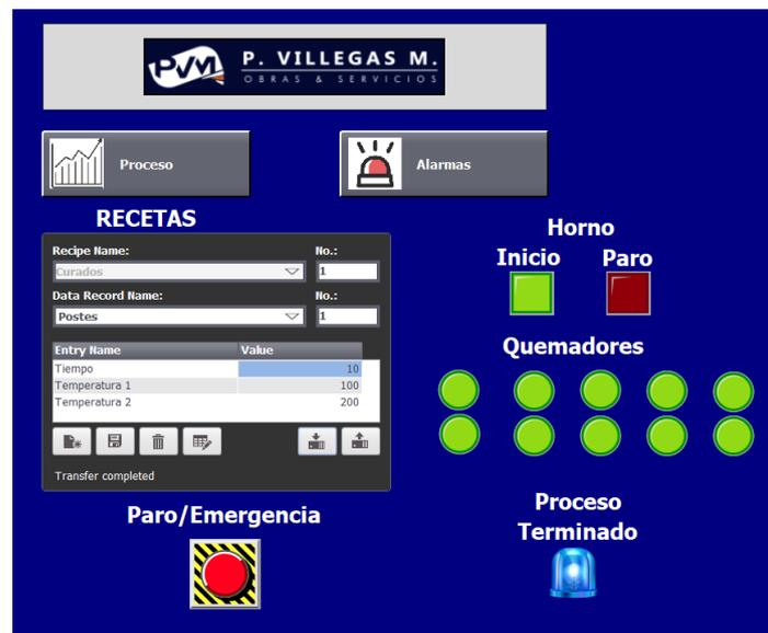
Figura 0.7 Pantalla inicial de Simulación en WinCC
