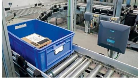
Figura 1-6. Sistema de identificación por radiofrecuencia SIMATIC RFID [8].
