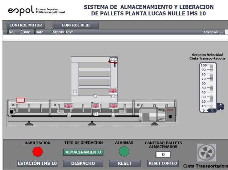
Figura 3-1. Pantalla para visualización y control de la estación de almacenamiento IMS 10.
