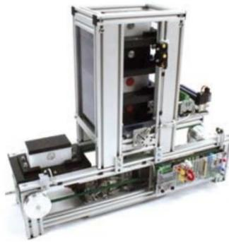
Figura 1-2. Subsistema mecatrónico de almacenamiento intermedio Lucas Nulle IMS10 [5].
