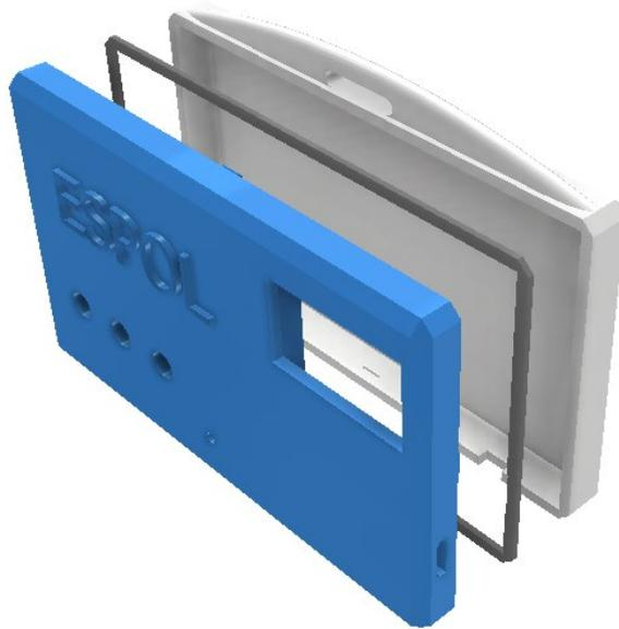
**Figura 3.1 Vista explotada del diseño 3D para la carcasa.**
