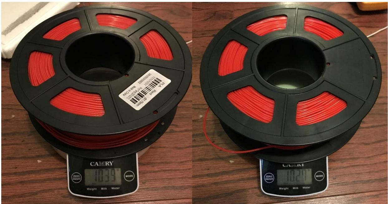
**Figura 3.14 peso del carrete antes y después del secado**
