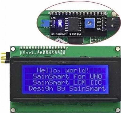
Figura 2.36 Pantalla LCD 20x4 con modulo I2C
