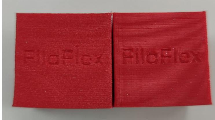
**Figura 1.9 Objeto impreso con filamento húmedo y sin humedad**
