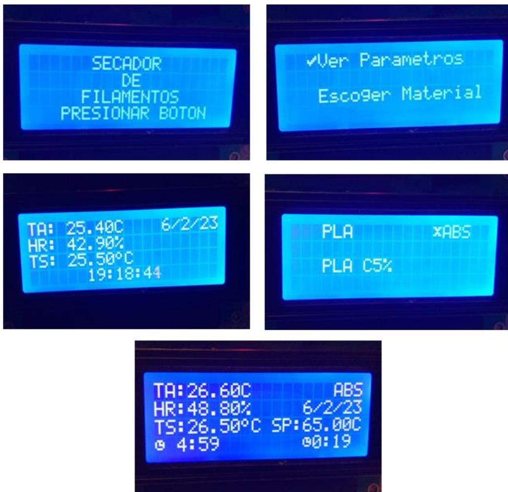
Figura 3.15 Prototipo de pantalla
