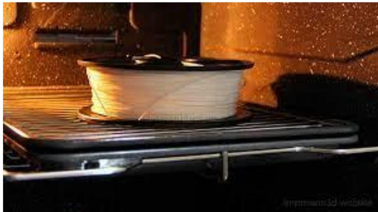
**Figura 2.1 Horno con carrete de filamento**
