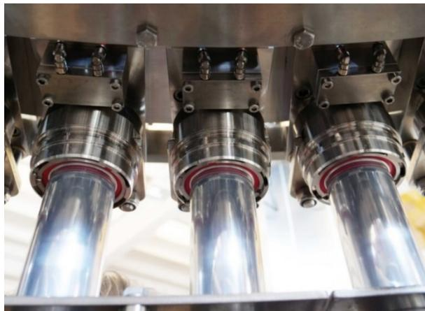
**Figura 2.2 Válvula electroneumática de sellado de latas [17]**
