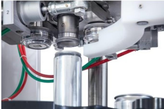
**Figura 2.1 Selladora de tapas (sistemas de rodillos) [16]**
