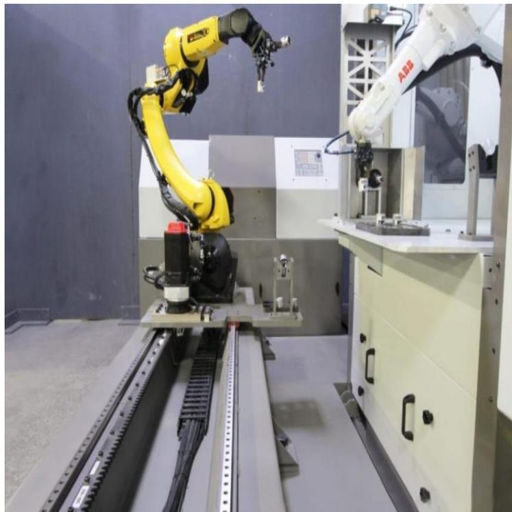
Figura 1.1 Brazo robótico unido a un RTU [7].
