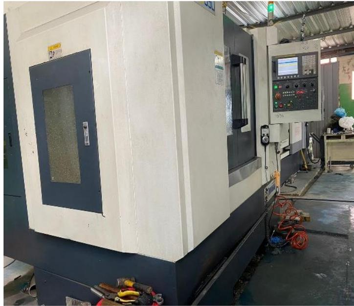
**Figura 1.7 Fresadora CNC VMC 650**
