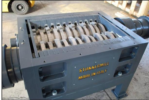
Figura 1.5 Sistema de trituración de doble eje [12].
