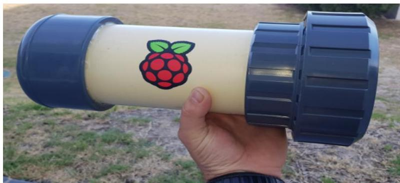
**Figura 1. 10 Prototipo casero de cámara submarina**
