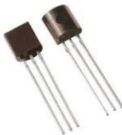
**Figura 2.3 LM35 encapsulado TO92.**
