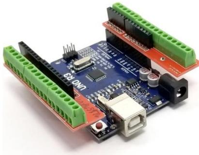
**Figura 2.5 Arduino Uno-Shield Bloque terminal.**
