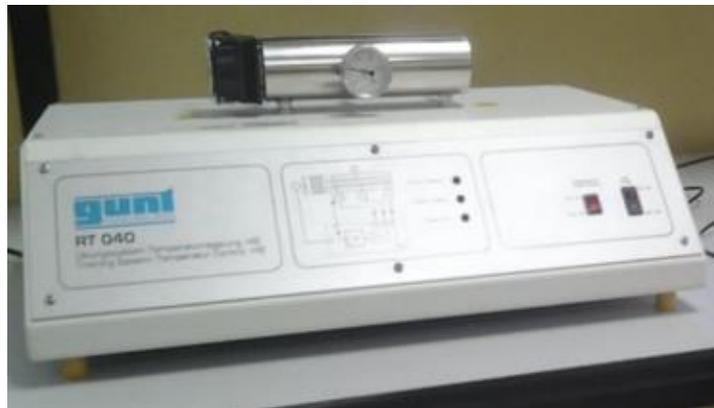
**Figura 1.5 Planta de Control de Temperatura GUNT RT040.**
