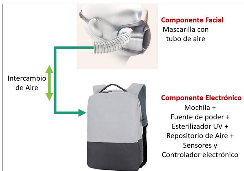
Figura 11: Partes del sistema de desinfección de aire.
