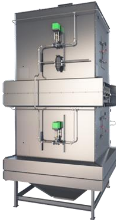
Figura 1.2 Post acondicionador de 2 piso. [7]
