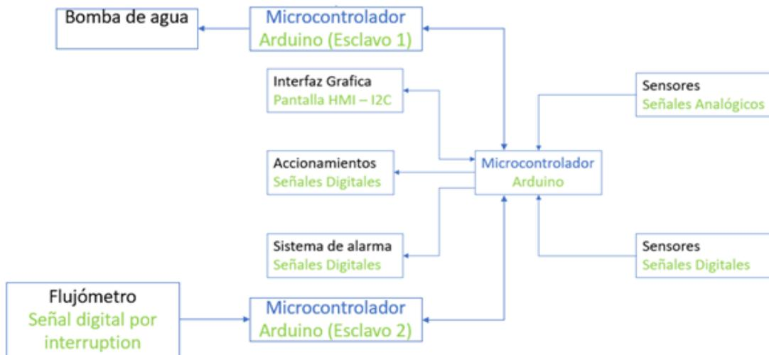
**Ilustración 10. Diagrama de comunicación del sistema**
