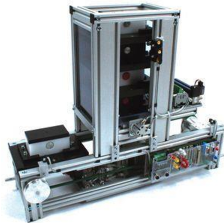
Figura 1.5 Estación de almacenamiento intermedio IMS 10.
