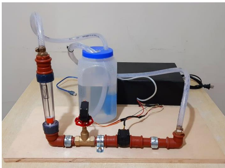
Figura 3.1 Prototipo de Planta didáctica de Control de Flujo
