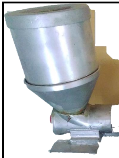
Fotografía 2 “Tanque tornillo sin fin acoplado al motor reductor”
