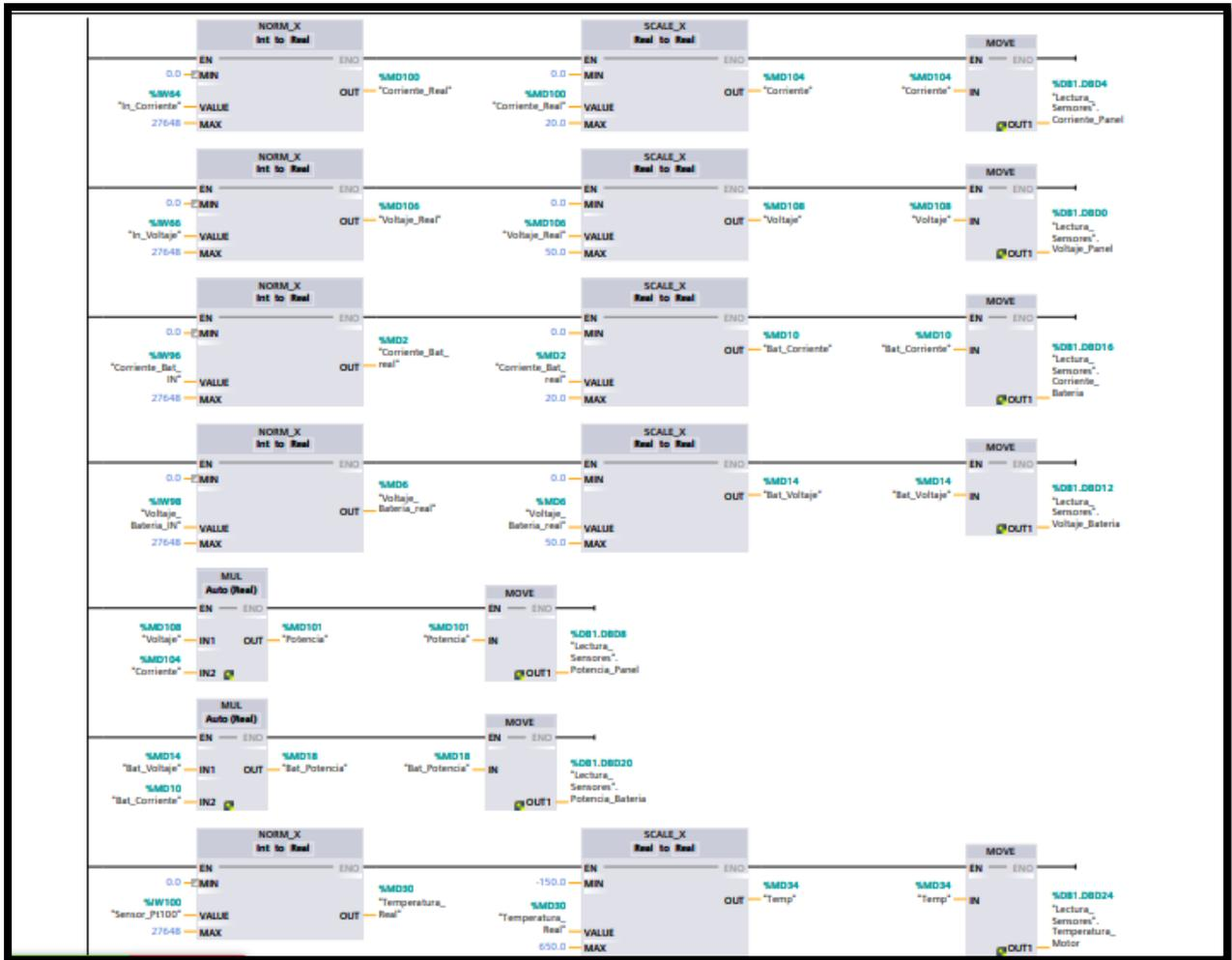
Segmento 3: Control de la potencia del panel y baterias(Automatico)
