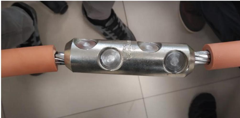
**Figura 2.3 Empalme que se suele utilizar para reconstruir a los cables de potencia (Mondragon Unibertsitatea, 2017)**
