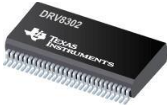
Figura 2.14. Vista del MOSFET driver DRV8302 para Montaje Superficial (SMD), (Texas Instruments, 2016)
